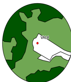
Slika 3. Primjer kartografskog prikaza preglednosti (postotka istraženosti) područja do 70 m oko vjetroagregata (bijelo-80-100%, svijetlo zeleno:40-80%, tamno zeleno: <40% istraženosti)
